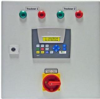
Die **Umschaltsteuerung DA-CM1-230** ermöglicht die Steuerung von zwei redundanten Drucklufttrocknern in einem Druckluftsystem. Die Trockner werden wechselweise durch automatische Umschaltung betrieben. Alle Trockner, die einen «Fern-Start/Stop-Kontakt» oder «Kompressor-Gleichlaufkontakt» besitzen, können ohne jegliche weitere Modifikationen direkt an die Umschaltsteuerung angeschlossen werden.
