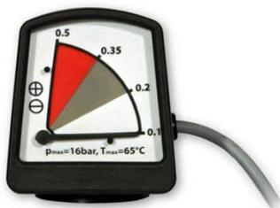
**Differenzdruckmanometer FAD01C mit potentialfreiem Alarmkontakt** ermöglichen die Einbindung der Differenzdrucküberwachung des Vor- und Nachfilters in die Sammelstörmeldung des Trockners. Um Fehlmeldungen durch Anfahr Situationen oder kurzzeitige Spitzen zu vermeiden, bieten die Trocknersteuerungen die Möglichkeit eine Verzögerungszeit zu definieren. Der Alarm wird dann nur aktiviert, wenn ein zu hoher Differenzdruck über die gesamte festgelegte Zeit ansteht.
