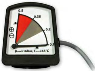
**Differenzdruckmanometer FAD01C mit potentialfreiem Alarmkontakt** ermöglichen die Einbindung der Differenzdrucküberwachung des Vor- und Nachfilters in die Sammelstörmeldung des Trockners. Um Fehlmeldungen durch Anfahrssituationen oder kurzzeitige Spitzen zu vermeiden, bieten die Trocknersteuerungen die Möglichkeit eine Verzögerungszeit zu definieren. Der Alarm wird dann nur aktiviert, wenn ein zu hoher Differenzdruck über die gesamte festgelegte Zeit ansteht.
