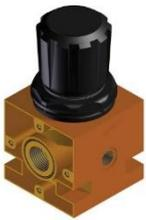
Der Zuluft-Druckregler steuert den Zuluft-Strom in Richtung der Druckbehälter, die eine ausreichende und stabile Einspeisung benötigen. Der Betriebsdruck sollte zu keinem Zeitpunkt unterhalb von 7 bar (g) liegen. Der Luftdruckregler regelt den Einlassluftdruck auf 6 - 7 bar (g), sofern er nicht manuell auf einen anderen Druck umgestellt wird.
