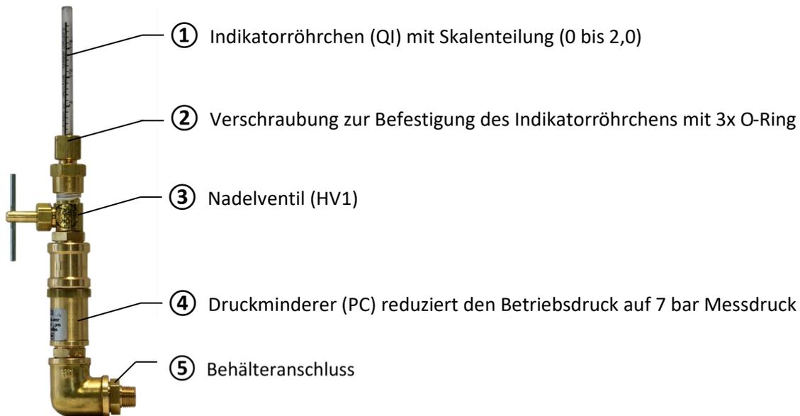
Wenn das Nadelventil ③ geöffnet wird fließt eine definierte Menge Druckluft durch das Indikatorröhrchen ①. Die weiße Beschichtung im Indikatorröhrchen nimmt das in der Druckluft enthaltene Öl auf. Das Öl löst einen roten Farbstoff und trägt den Farbstoff allmählich im Indikatorröhrchen nach oben. Die fortschreitende Verfärbung ist proportional zur Ölmenge, die in das Indikatorröhrchen eingetragen wird.
